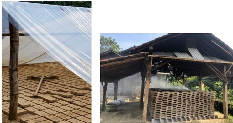
**Gambar 5 Proses pencetakan dan pembakaran batu bata di Desa Srimulyo**
