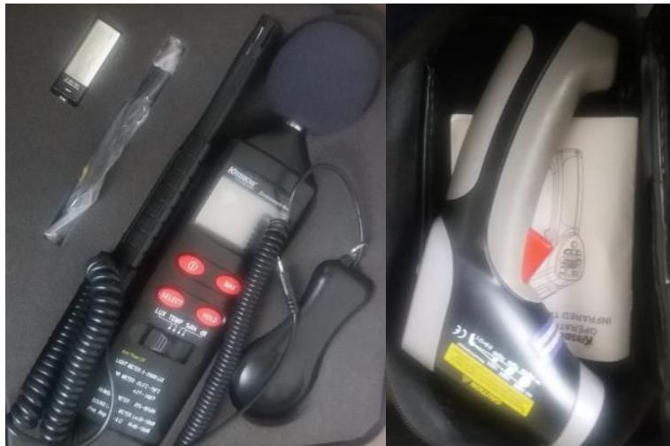
Gambar 4. Alat pengukuran, Kiri: Environment meter ; Kanan: Infra-red meter Sumber : Dokumentasi Yusintha,2019
