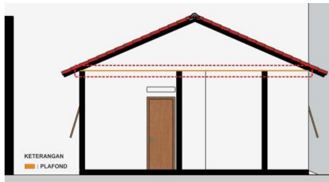
Gambar 8. Letak plafon horizontal
