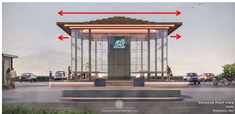
Gambar 8. Penerapan atap limasan pada tritisan entrance Dokumen Perancangan Putri Bali Group, dengan analisis penulis, 2023
