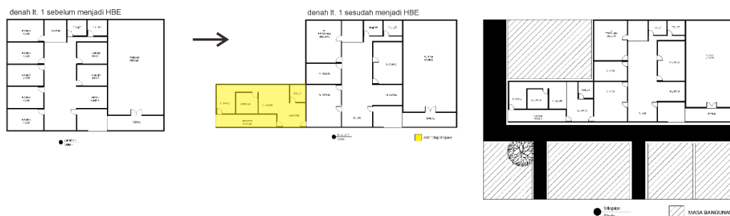
Gambar 5. Denah lantai 1 sebelum dan sesudah menjadi HBE
