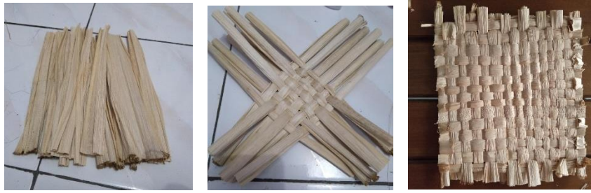
Gambar 2. Cara pembuatan sampel anyaman pelepah pisang
